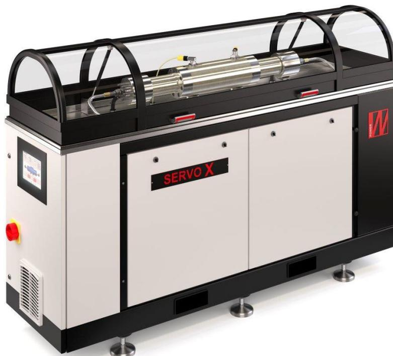
SERVO™ est une pompe d'intensification HYBRIDE à haut rendement (90%) dotée d'un système hydraulique à ouverture progressive BREVETÉ, capable de générer une pression allant jusqu'à 4.150 bar, améliorant efficacité et sécurité. La commande numérique synchronise les cycles de travail de la pompe en assurant une économie d'énergie de 37% par rapport à une pompe intensificatrice oléodynamique traditionnelle alimentée par un moteur asynchrone.
